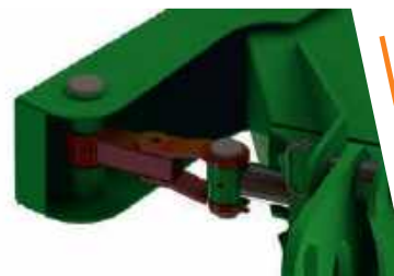
Шатун – для передачи вращающего момента
