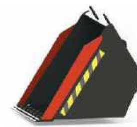
Режущая кромка усилена
