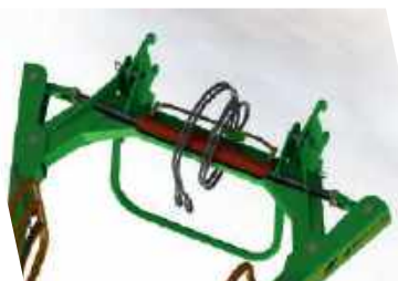
Гидроцилиндр двухстороннего действия жестко закреплен в корпусе рамы
